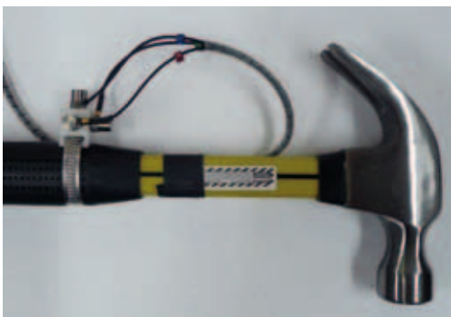
Abb.7. Schwingungsbelastungsmessung beim Handhammer
