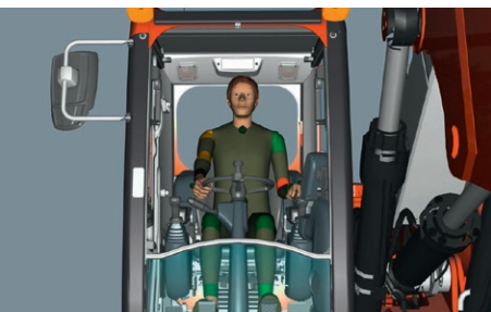
VR-Greifraumanalyse in einer Baggerkabine
